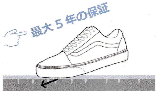
微細な穴に水を押し込み水の移動を抑えるので滑らない
